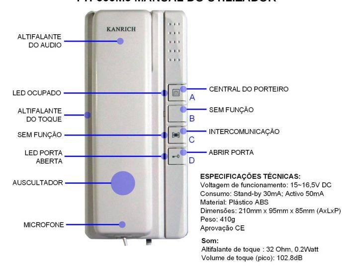
CHAMADA DO POSTO EXTERNO - O intercomunicador toca e liga o LED "Ocupado" mas o áudio não é activado, permanecendo neste estado durante 30 seguntos. Para falar levante o "Auscultador". Terminada a conversação pouse o "Auscultador" (o intercomunicador desligar-se-á automaticamente após 3 minutos).
